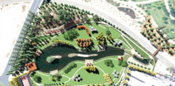
**PROCESO DE LLENADO:** El llenado del parque se producirá lentamente, gracias a su gran superficie, lo que minimiza el riesgo de que se produzcan desgracias personales. El volumen total de agua que se puede almacenar, 45.000 m<sup>3</sup>, corresponde a una lluvia de fuerte intensidad y 2 horas de duración. Si se superara la capacidad del parque se produciría un alivio a la superficie de la avenida de Oviedo.
